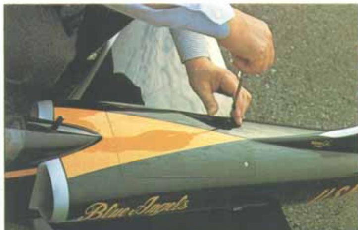
○胴体上面のハッチはカムロックでワンタッチで閉閉。ハメ合いに一分のスキもない。
