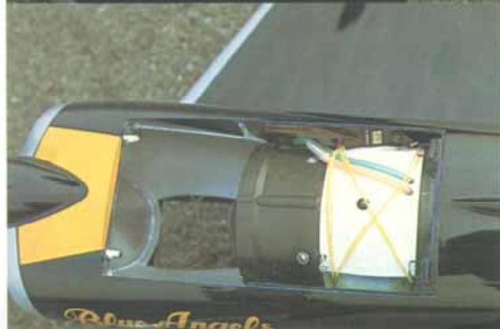
○ダクト前方胴体下部の「ダマシ穴」はダクトファン内蔵機体に不可欠の空気取入口。
